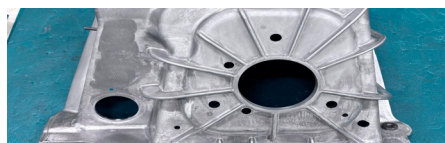
铝合金一体化压铸前减震塔
